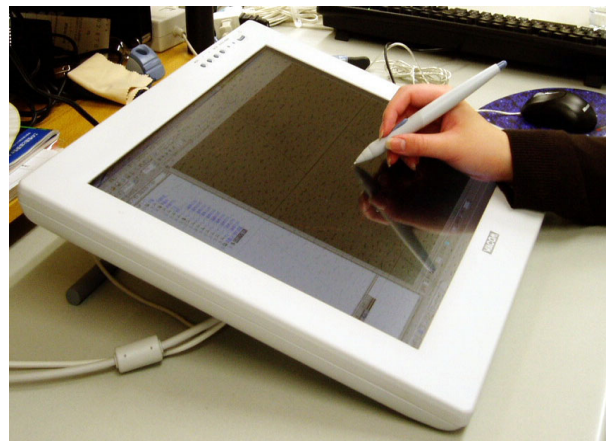
写真-3 トレースによる変状展開図作成
